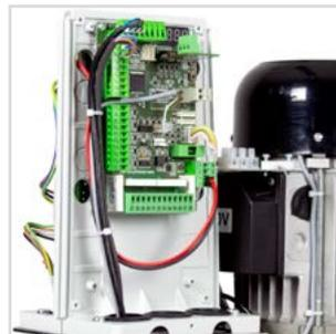
Больше скорости и больше контроля с новой платой управления NET230-EVO-I со встроенной инверторной технологией.
